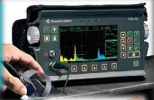
ULTRASONIDO CALIBRACION DE PALPADORES ANGULARES CON LA PROBETA V1.1
